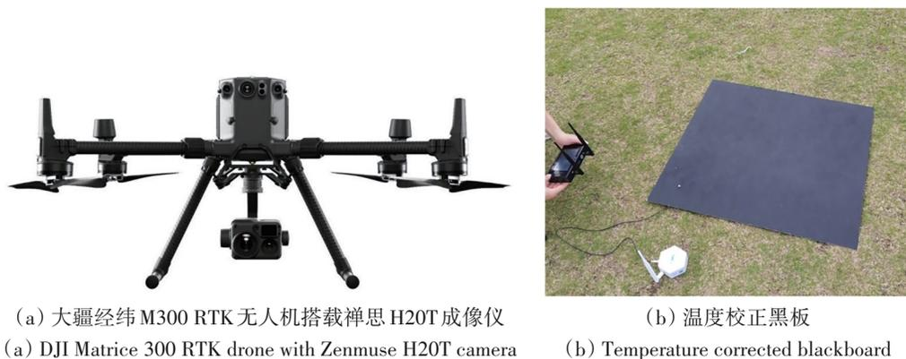
图2 无人机搭载热红外成像仪及温度校正黑板
