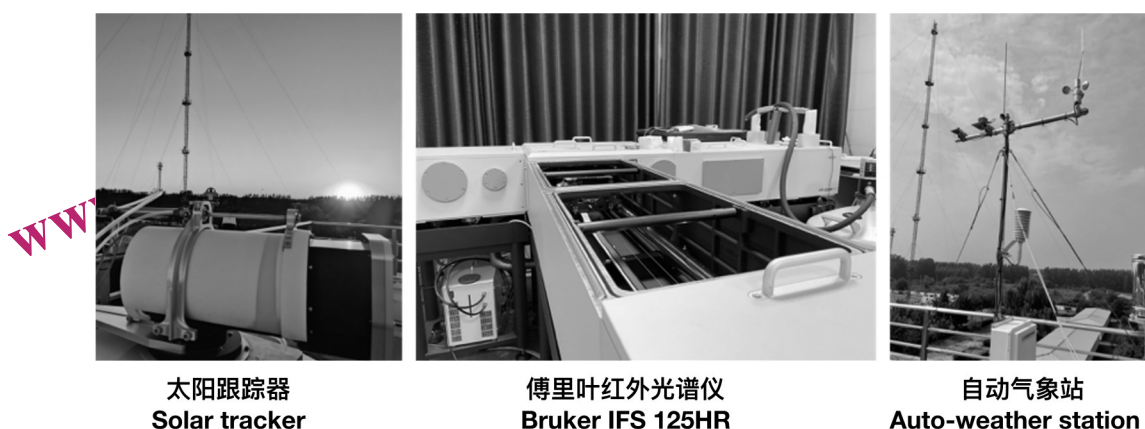
图1 香河站Bruker IFS125HR FTIR观测系统,包括太阳跟踪器(左),高分辨率傅里叶光谱仪(中),以及自动气象站(右)。
