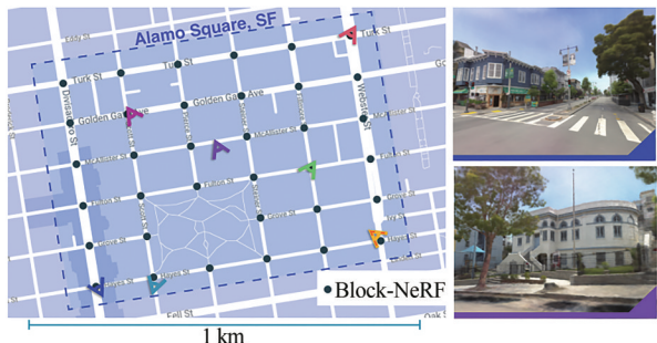
图6 基于Block-NeRF构建旧金山阿拉莫广场社区实景三维场景(Tancik等,2022)
