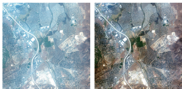
(a) 美国加州地区复杂地表上空大气校正前图像 (a) Image before atmospheric correction over a complex surface (b) 大气校正后图像 (b) Image after atmospheric correction
