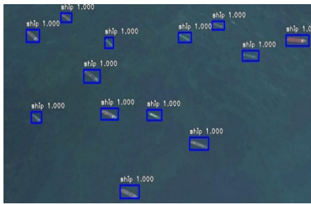
(b) NWPU VHR-10数据的检测结果 (b) Test result from NWPU VHR-10
