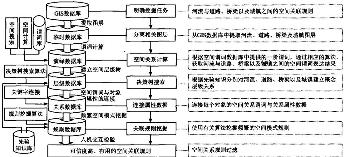
图 2 GIS 空间关联规则挖掘的基本框架
